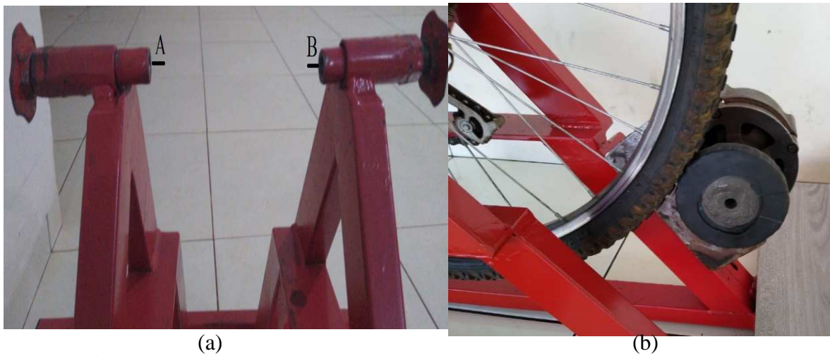
Figura 2.3 – Imagem fotográfica apresentando (a) os pontos de apoio do eixo traseiro da bicicleta, do qual os pontos A e B possuem roscas compatíveis com o respectivo eixo, e (b) a maneira em que a polia e os pneus ficam dispostos.
