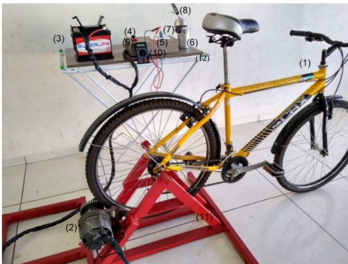
Figura 2.1 – Imagem fotográfica da montagem experimental constando o aparato experimental denominado de “bicicleta dinâmica”. Em que: (1) bicicleta, (2) alternador automotivo (12 V – 35 A) com polia modificada para dentada, (3) bateria automotiva de 12V -35 A, (4) chave de luz universal - 3 Posições, (5) conjunto de duas tomadas residenciais, (6) porta latas térmico de alumínio de 350 ml com tampa, (7) resistor elétrico para chuveiro de 110 V, (8) termômetro digital tipo vareta, (9) uma mini lâmpada 12 V – 5 W, (10) multímetro, e (11) estrutura metálica, (12) móvel para colocar parte do material.
