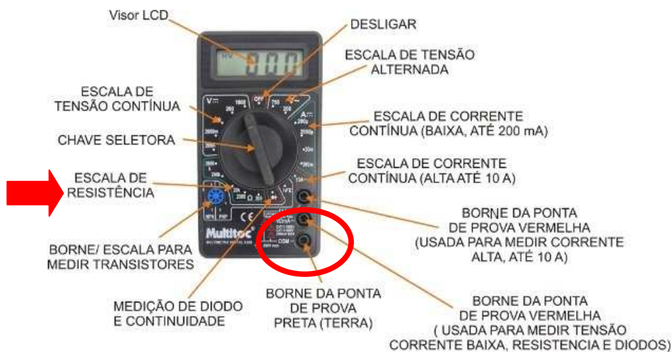
Figura 13- Ilustração das “partes” da escala e conexões de um multímetro.
