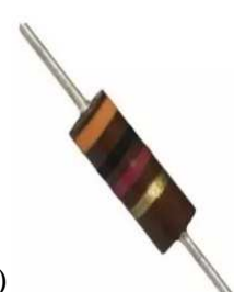
Figura 1.13- (a) Desenho esquemático de um resistor de carvão com suas respectivas faixas de cores que indicam o valor de sua resistência. Imagem fotográfica da composição de um resistor (b) a carvão e (c) de cerâmica, com as faixas de cores.
