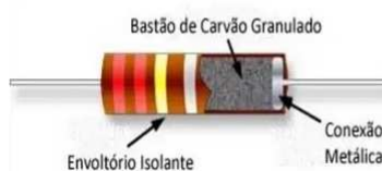
Figura 1.13- (a) Desenho esquemático de um resistor de carvão com suas respectivas faixas de cores que indicam o valor de sua resistência. Imagem fotográfica da composição de um resistor (b) a carvão e (c) de cerâmica, com as faixas de cores.
